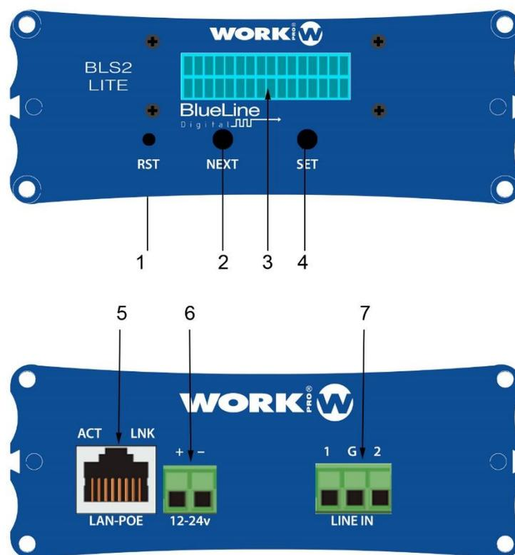
1. **Botón de Reset.** Lleva el dispositivo a su configuración de fábrica
